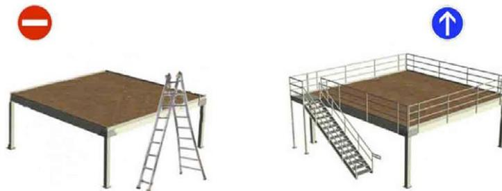
**L'entreprise en charge de la construction et du démontage d'une mezzanine, d'un chapiteau à étage, scène, tribune, structure... doit mettre en place pour la livraison, l'approvisionnement ou le retrait de matériel en hauteur, un système assurant à tout moment une protection collective des personnes travaillant en hauteur (Recette à matériaux, rampe munie de protections...).**
